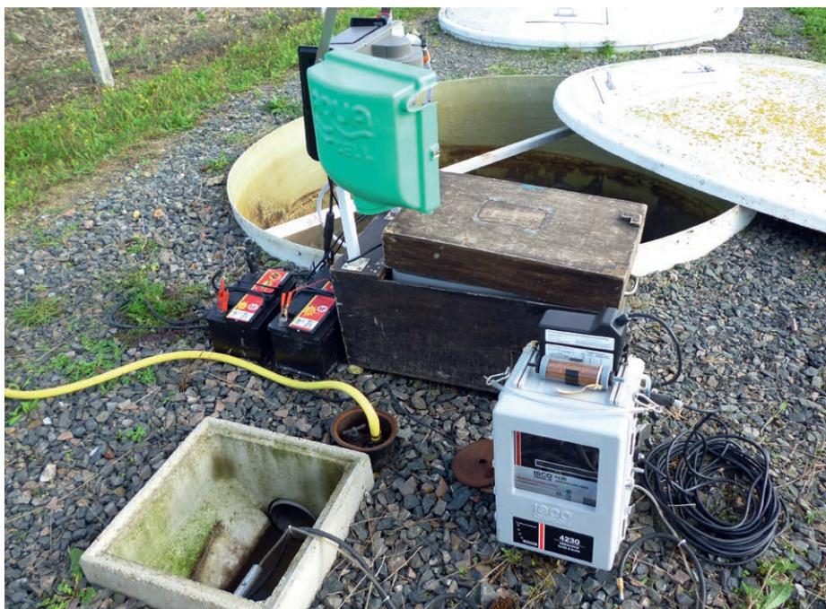
Mise en œuvre d'un bilan 24 heures sur une station sans électricité.
