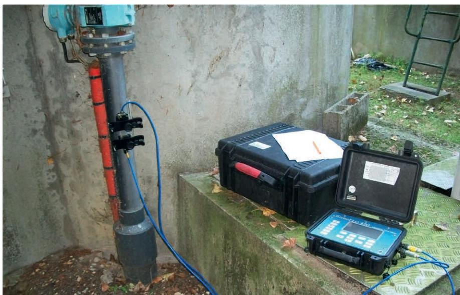
Vérification d'un débitmètre électromagnétique (entrée station).
