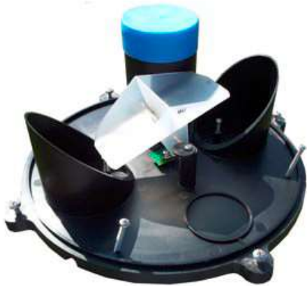
Pluviomètre autonome à augets basculant
